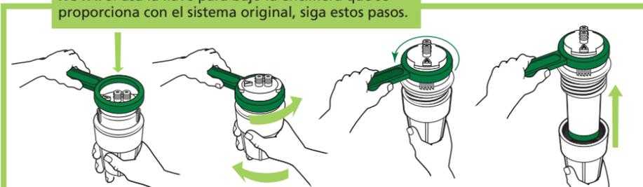
**5** Inserte y conecte el nuevo cartucho de filtro en la mitad superior del sumidero. Gire y apriete la parte inferior del sumidero hacia la derecha para volver a conectarla con la mitad superior.
