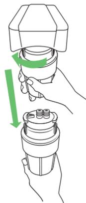
**4** Afirme el sumidero del cartucho sobre el fregadero. Gire la parte inferior del sumidero hacia la izquierda para separar sus dos piezas. Vierta el exceso de agua por el drenaje. Tire el cartucho de filtro hacia abajo para desconectarlo de la mitad superior del sumidero.
